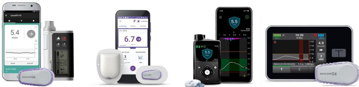
У гібриду зачиненої петлі (HCL) є система котра передбачає один із видів насосів, які працюють разом з системою CGM.
